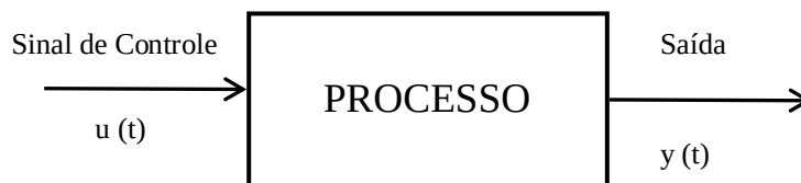
Figura 3 Diagrama em blocos de um sistema de controle em malha aberta.
